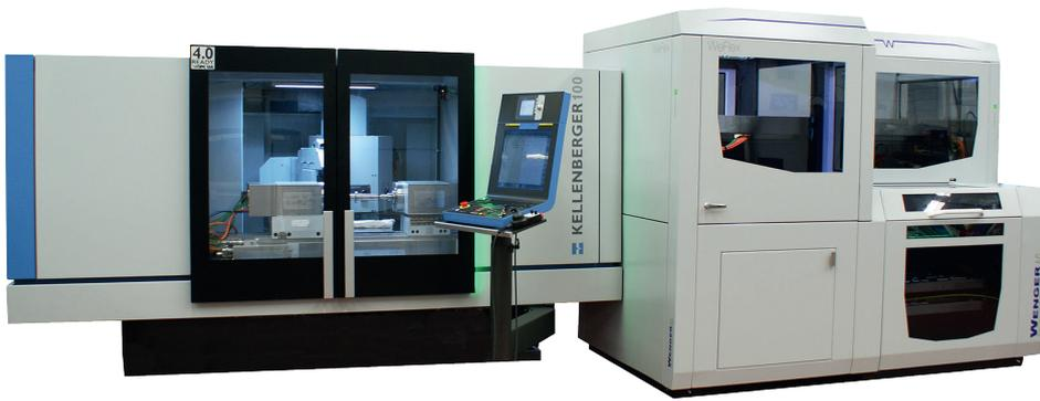
2 Die Rundsleif-Plattform Kellenberger 100 mit adaptiertem WeFlex-Lader von Wenger für Wellen- und Futterteile (© Hardinge)
